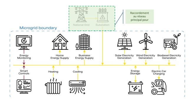
Figure 1 - Schéma de la portée typique de l'opérateur de réseau (avec l'aimable autorisation de Vattenfall)
