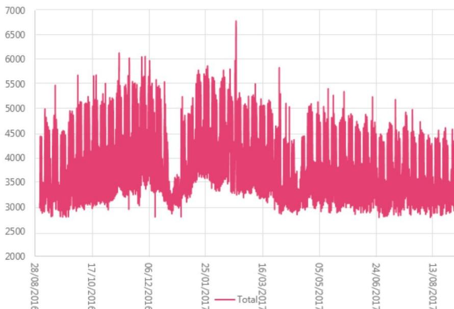
Figure 15 Demande électrique annuelle mesurée sur le campus en kW.
