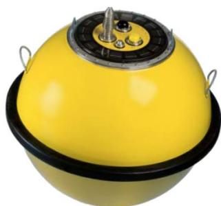
**Figure 3 :** Bouée Waverider (NNRCMP, 2022)
