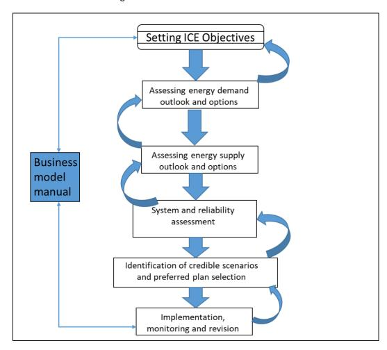
Figure 5.1 Vue schématique de l'approche méthodologique d'ICE
