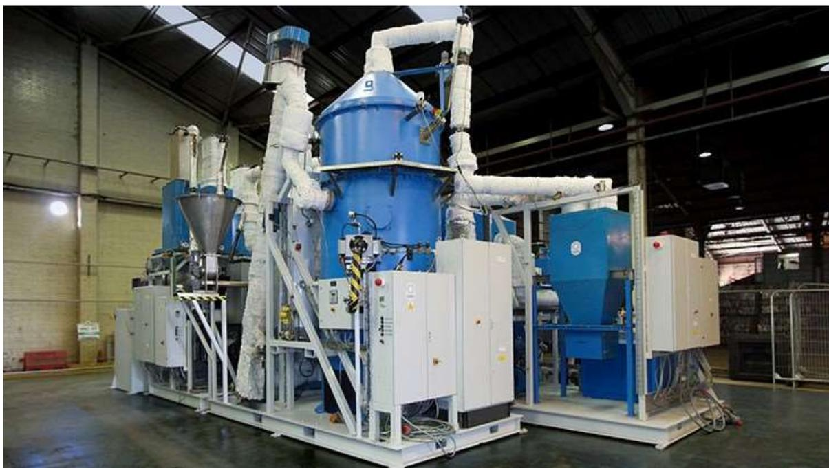
**Figure 3-9 : Le processeur Plaxx RT7000 permettant de convertir des plastiques mixtes en carburant (source : Recycling Today, 2017)**
